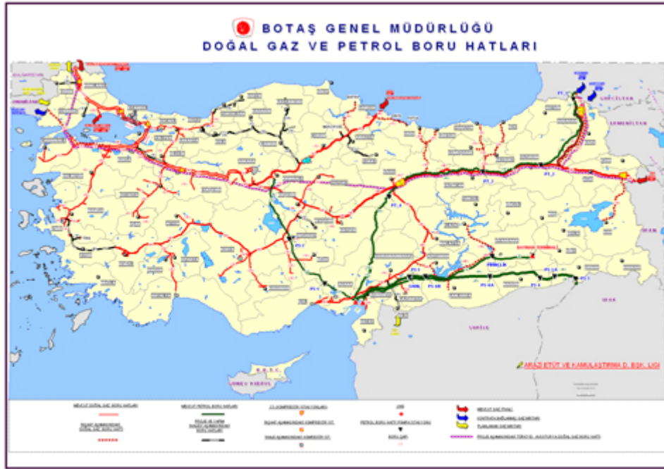
Şekil 4. Doğalgaz ve petrol boru hatları
